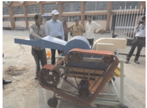
चित्र 2. कदन्न फसलों के लिए विकसित शक्ति चालित गहाई एवं मड़ाई यंत्र
