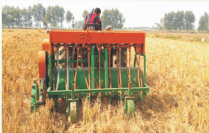
ਚਿੱਤਰ ਨੰ. 1: ਝੋਨੇ ਦੀ ਪਰਾਲੀ ਵਿੱਚ ਹੈਪੀ ਸੀਡਰ ਦੁਆਰਾ ਕਣਕ ਦੀ ਸਿੱਧੀ ਬਿਜਾਈ
