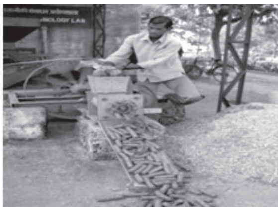
पैलेटिंग मशीन द्वारा फीड पैलेट का निर्माण
