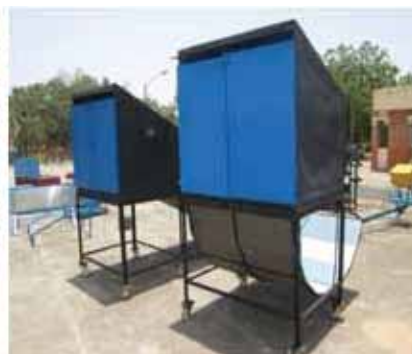
चित्र 8.6 सौर ऊष्मा भंडारण व उलट-अवशोषक वाले सौर शुष्कक का प्राकृतिक संवहनी के साथ योजनाबद्ध आरेख Fig. 8.6 Schematic view of reversed absorber with thermal storage natural convective solar crop dryer
