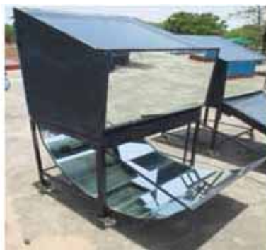
चित्र 8.6 सौर ऊष्मा भंडारण व उलट-अवशोषक वाले सौर शुष्कक का प्राकृतिक संवहनी के साथ योजनाबद्ध आरेख Fig. 8.6 Schematic view of reversed absorber with thermal storage natural convective solar crop dryer
