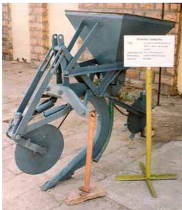
चित्र 8.11 ट्रैक्टर चलित खाद डालने की मशीन Fig. 8.11 Tractor drawn FYM applicator
