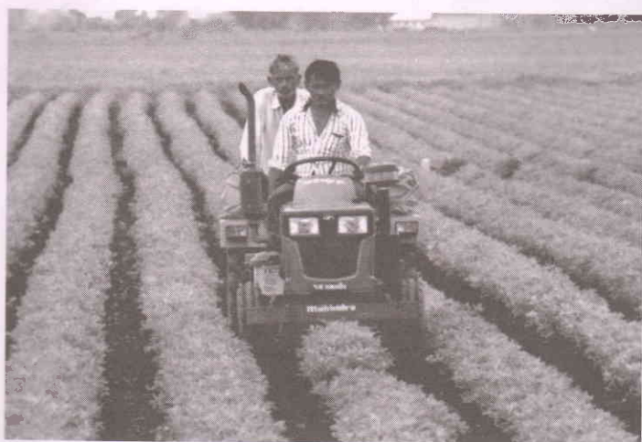
चित्र सं.1 मूँगफली में मिनी ट्रैक्टर (बायें) तथा बेलों (दायें) द्वारा चालित ब्लेड हेरो से अन्तरूफसल क्रिया।
