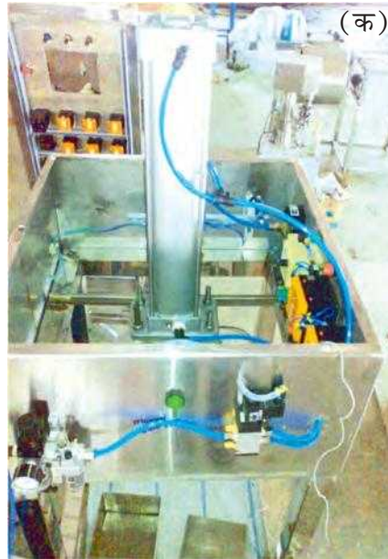
पनीर प्रेसिंग स्वचालित मशीन क) एफआरएल यूनिट व सोलेनोइड वाल्व ख) पीआईडी कंट्रोलर, टाइमर फ्रंट पैनल व पनीर प्रेस
