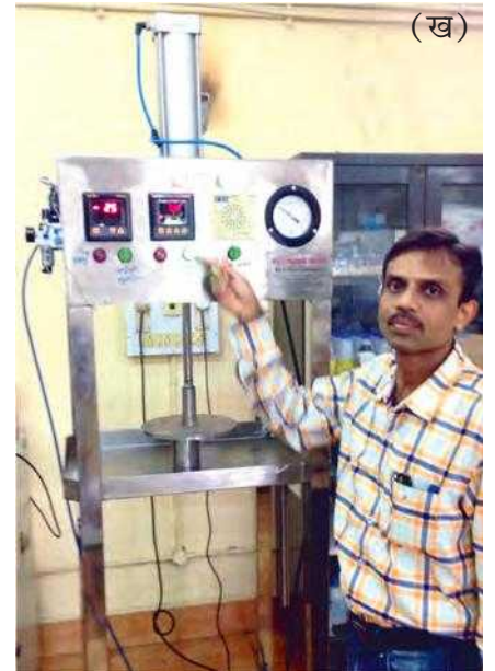
पनीर प्रेसिंग स्वचालित मशीन क) एफआरएल यूनिट व सोलेनोइड वाल्व ख) पीआईडी कंट्रोलर, टाइमर फ्रंट पैनल व पनीर प्रेस
