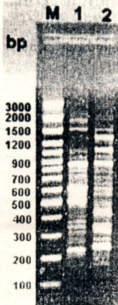
Fig. RAPD-PCR using 10 mer random primer OPG 10. Lane M : Marker (Generuler), Lane 1 : M. mycoides subsp. mycoides SC (PG 1), Lane 2 : M. mycoides subsp. mycoides SC (NCVP - 1/86)
