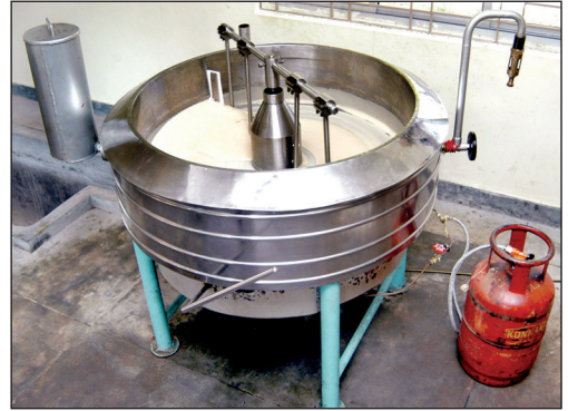
चित्र 8 नारियल दूध कुकर में नारियल दूध का तापन
