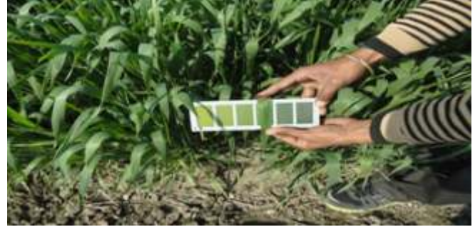
गेहूँ के पौधों में नत्रजन की मात्रा निर्धारण करने हेतु लीफ कलर चार्ट का प्रयोग
