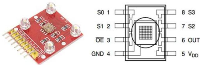
Fig. 3. TCS3200 Color Sensor Module
