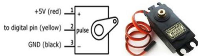
Fig. 2. Servo motor
