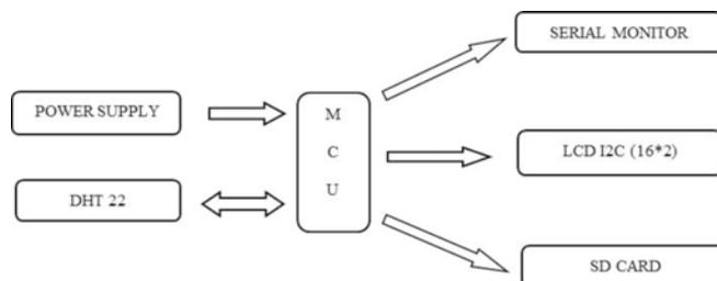
Fig. 10. Block Diagram of Data-Logger
