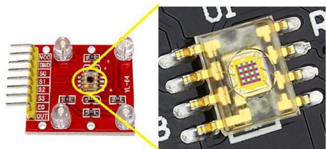
Fig. 4. Photodiode array
