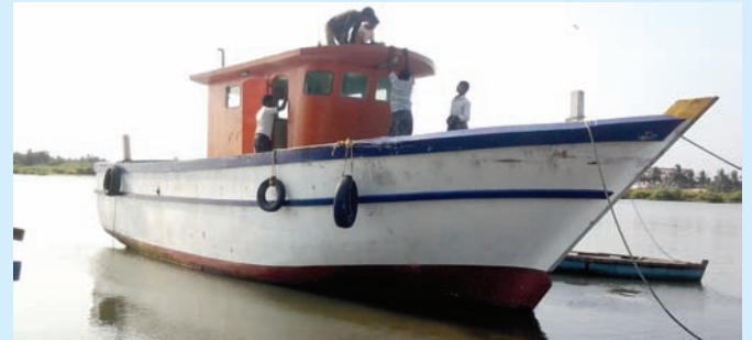
अंडमान एवं निकोबर द्वीप के लिए 13.7 मी L_{OA} एफ आर पी ट्यूना मत्स्यन यान कुडल्लूर में स्थिरता परीक्षण के लिए तैयार
