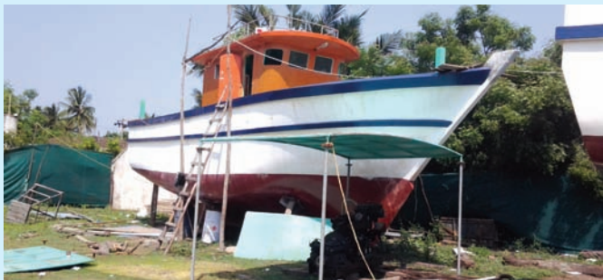
अंडमान के लिए कुडल्लूर में निर्माणाधीन 13.7 मी L_{OA} एफ आर पी ट्यूना मत्स्यन यान
