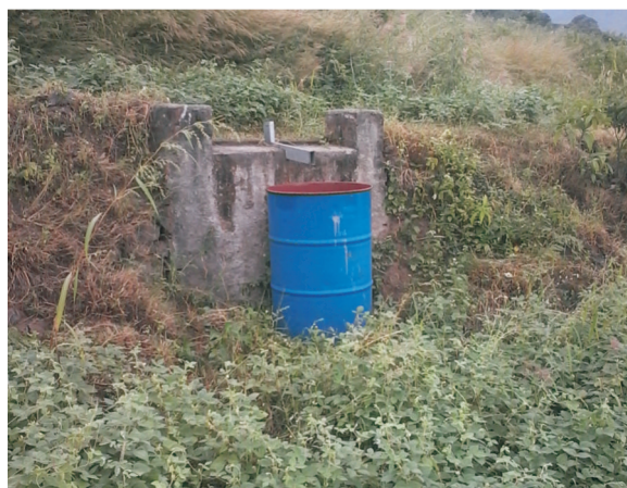
Photo 3.2: Runoff measuring device in kulthi crop फोटो 3.2: कुलथी फसल में अपवाह मापक यंत्र
