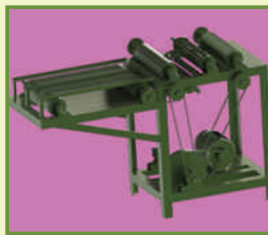
चित्र सीआरपी/निर्जाफ्ट 01.2: अनानास की पत्ती का रेशा निकालने वाली मशीन
