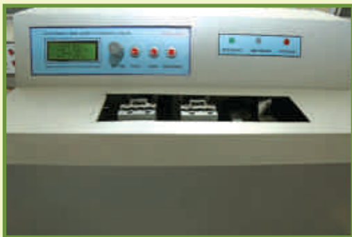
चित्र सीआरपी / निर्जाफ्ट 02.3 रैमी रेशा बंडल की शक्ति परीक्षण करने का डिजिटल यंत्र
