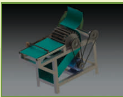
चित्र सीआरपी/निर्जाफ्ट 01.1: स्वचालित भरण प्रणाली युक्त सीसल रेशा निकालने वाली मशीन
