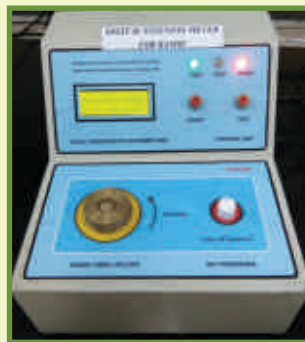
चित्र सीआरपी / निर्जाफ्ट 02.4: रैमी रेशा की बारीकी का परीक्षण करने का डिजिटल यंत्र
