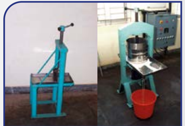
चित्र 1. हस्तचालित नारियल दूध निकालने की मशीन
