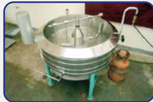
चित्र 8. वर्जिन नारियल तेल निकालने के लिए कुकर
