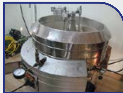
चित्र 9. कृषि अवशिष्टचालित वर्जिन नारियल तेल कुकर
