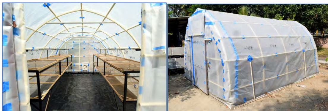
Fig. 4. ICAR-CIFT Solar-tunnel dryer
