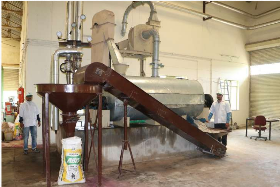
चक्रिय नलिका ड्रम ड्रायर का नमूना और चक्रिय नलिका ड्रम ड्रायर के विभिन्न घटक
