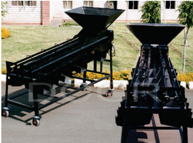
मोटरचालित प्याज श्रेणीकरण यंत्र / Motorized onion grader
